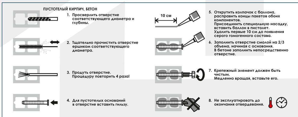
Хранение и транспортировка химического анкера должны производиться в герметично закрытой таре. Допускается до 5 циклов замораживания - размораживания (цикл - не более суток) при температуре до -18°C, или однократное замораживание до -18°C сроком не более 7 суток. Размораживание производится без дополнительного нагрева при температуре до +20°C. Хранение химического анкера осуществляется в теплом складе при температуре не ниже +5°C.
